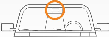
En parabrisas con recubrimiento metálico: en estos casos el dispositivo debe colocarse dentro de las áreas señaladas en el parabrisas, donde no hay recubrimiento. Estas áreas normalmente están marcadas.
